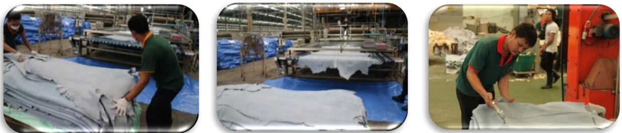
รูปภาพที่ 2 : หนังพื้นและหนัง Wet Blue
